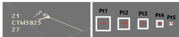
Figure 4 : la comète Radar utilisée par les contrôleurs aériens
